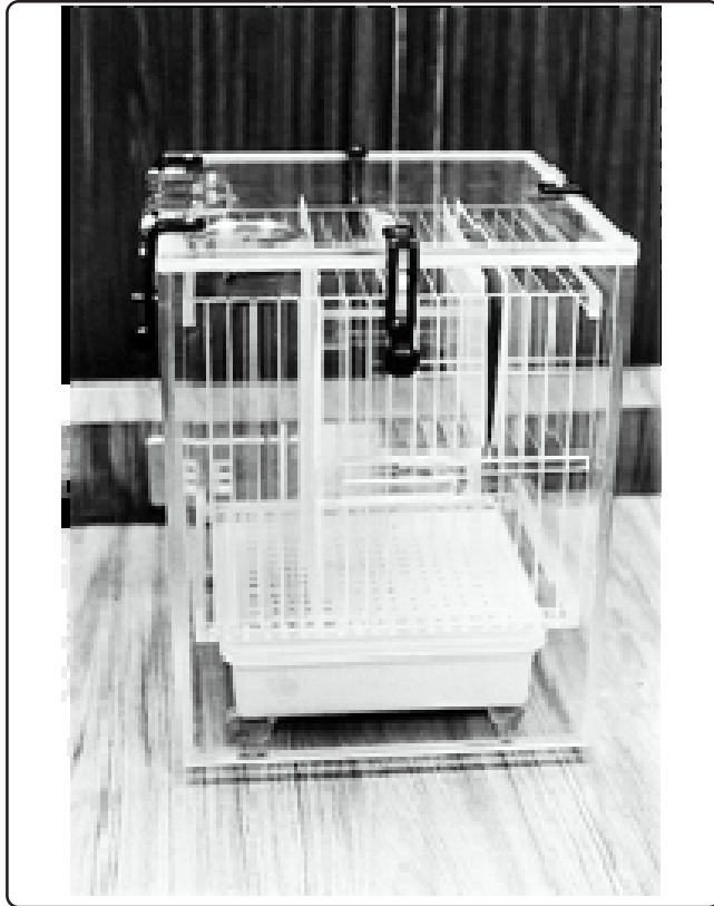
Figura 3. Cámara para estabilizar los filtros a humedad y temperatura constantes.
