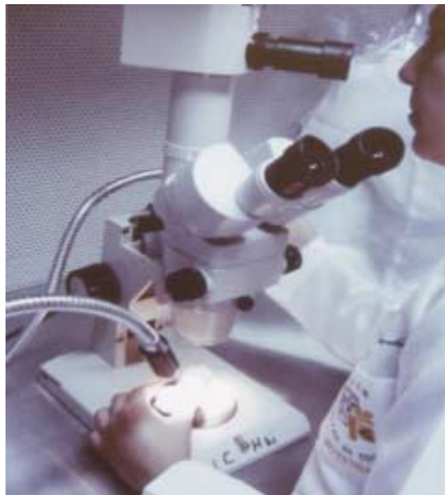
Figura 5. Microscopio electrostático con cámara Nikon FX-35W, con el que se fotografiaron las muestras en su corte transversal.
