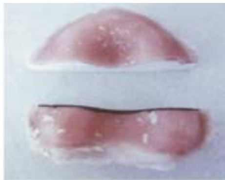
Figura 4. Muestras en las que se observa el corte transversal efectuado con una sierra eléctrica.
