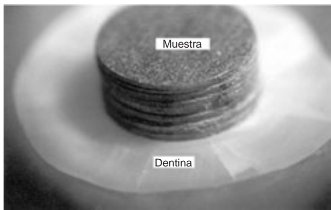
Figura 8. Superficie de una muestra de amalgama después de su desalojo de una cavidad en dentina. Se observan en la pared de la muestra las huellas nítidas del corte de la fresa de la superficie de la dentina impresas en ésta.
