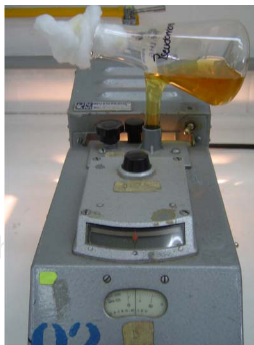
Figura 1. Calibración con el nefelómetro de McFarland cuya turbidez debe ser igual a la del tubo 0.5 de la escala de McFarland.
