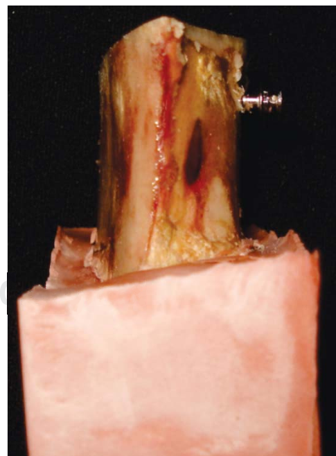
Figura 2. Muestra con el miniimplante perpendicular a la dirección de la fuerza.
