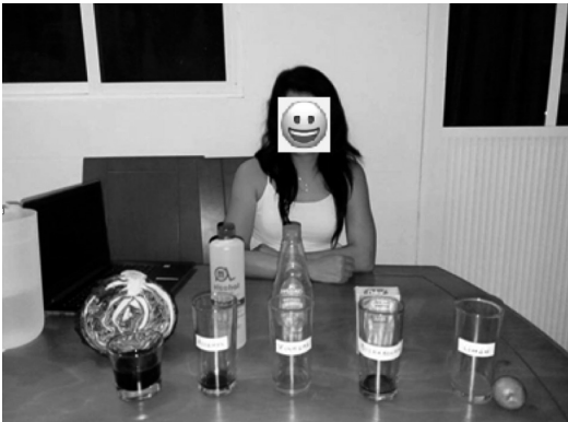
Figura 5. Determinando el pH utilizando un repollo morado y sustancias químicas caseras como el alcohol, vinagre, bicarbonato de sodio y jugo de
