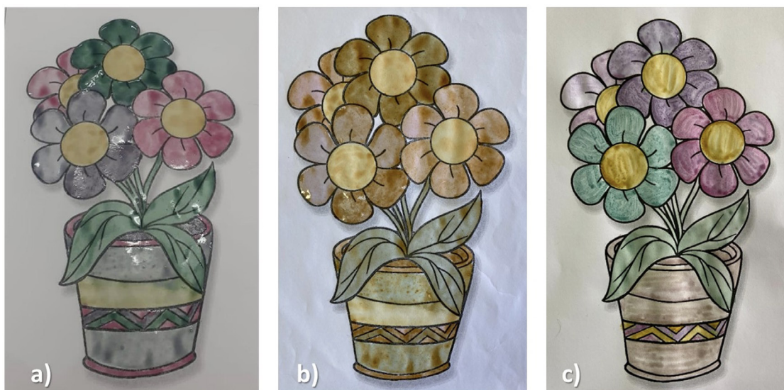
FIGURA 2. Dibujos coloreados con acuarelas obtenidas a partir del extracto convencional (a y b, sin tratamientos ni aditivos) y diferencial (c, con BHT como aditivo). La Figura 2a muestra el dibujo inicial; la Figura 2b, el mismo dibujo al cabo de dos meses. La Figura 2c muestra el dibujo pintado con acuarelas obtenidas a partir del extracto diferencial, también dos meses después de su aplicación.
