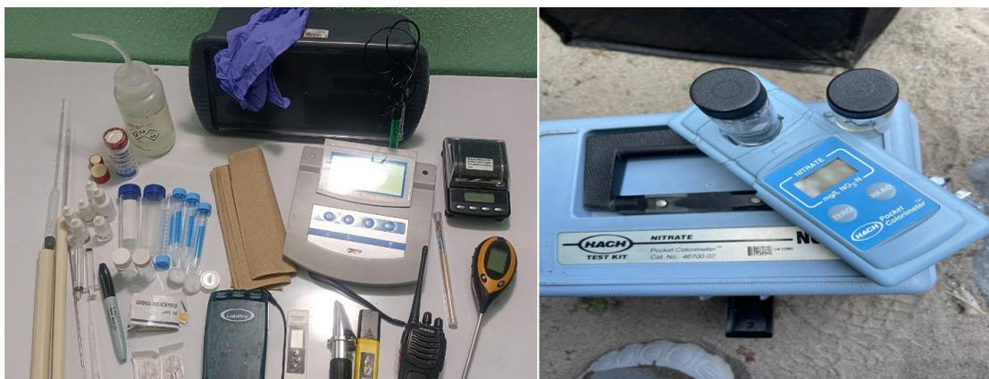
Con las muestras recolectadas y utilizando las mismas técnicas, en el laboratorio se repitieron los experimentos de los puntos 2 y 3, es decir, el análisis volumétrico y la colorimetría para la determinación de la concentración de nitritos y nitratos.
