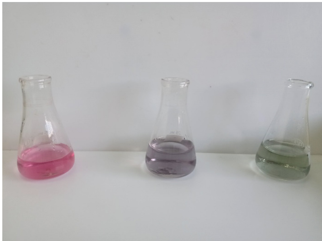
FIGURA 6. Colores obtenidos para la titulación ácido/base empleando la Mezcla B como indicador. Antes (izquierda) y después (derecha) del punto de equivalencia (centro).
