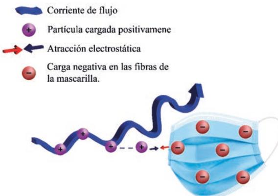
**FIGURA 6.** Mecanismo de atracción electrostática.
