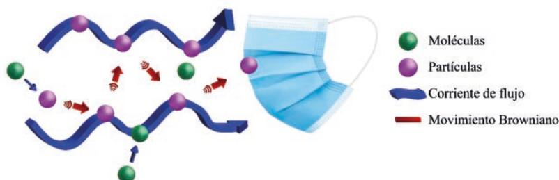
Por otra parte, el mecanismo de atracción electrostática (Figura 6), se debe a que los filtros fibrosos son elaborados a partir de fibras cargadas, en donde, las partículas con carga opuesta son atraídas electrostáticamente por las cargas de la fibra, por lo tanto, este mecanismo ayuda a la recolección de tamaños de partículas tanto grandes como pequeñas presentes en la corriente de flujo.
