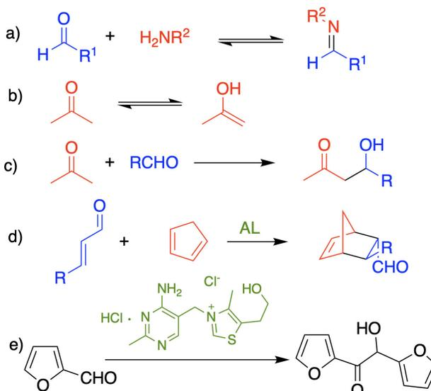
**FIGURA 14.** (a-d) Reacciones estudiadas en cursos de licenciatura que pueden formar un andamiaje para impartir organocatálisis. (e) Reacción de condensación benzoínica para llevarse a cabo en laboratorio.
