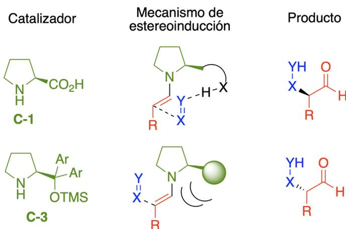
**FIGURA 8.** Comparación de los catalizadores **C-1** y **C-3** para dirigir la introducción del electrófilo en enaminas.
