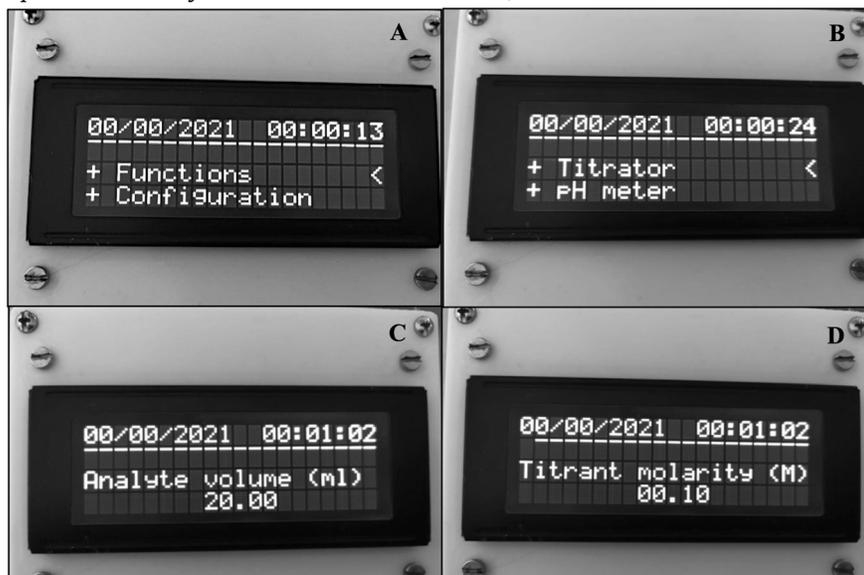
**FIGURA 8.** Instrucciones para el Titulador: A. Primer menú: funciones y configuración. B. Segundo menú: titulador y medición de pH. C. Tercer menú, se indica el volumen del analito. D. Cuarto menú, se indica la molaridad del titulante.
