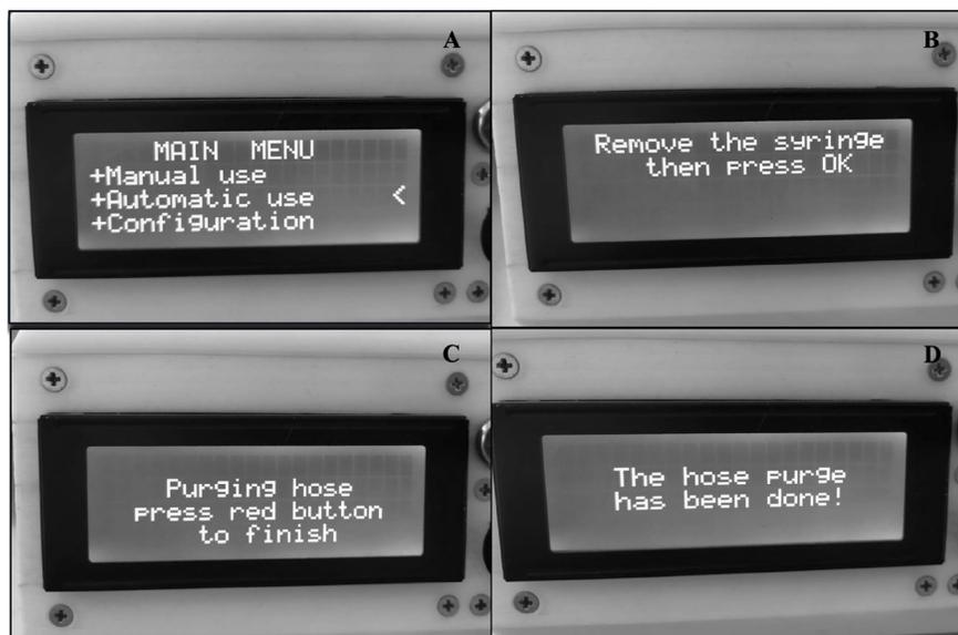
**FIGURA 9.** Instrucciones para el Dosificador. **A.** Modo automático. **B.** Removemos la jeringa. **C.** Realizamos la purga. **D.** Terminamos la purga.
