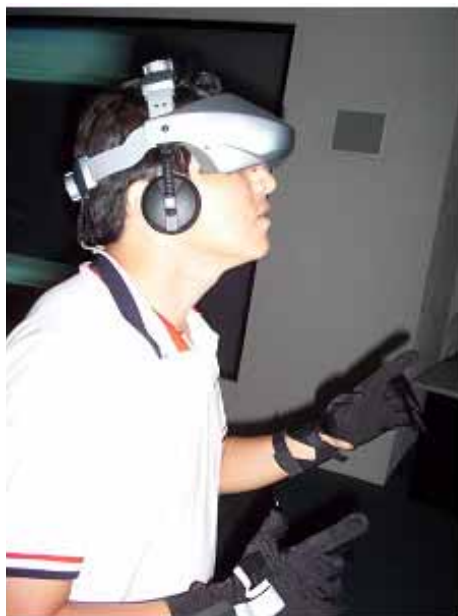
Figura 5. Sistema de RV completamente inmersivo. Imagen cortesía del Laboratorio de Realidad Virtual, U. de C.
