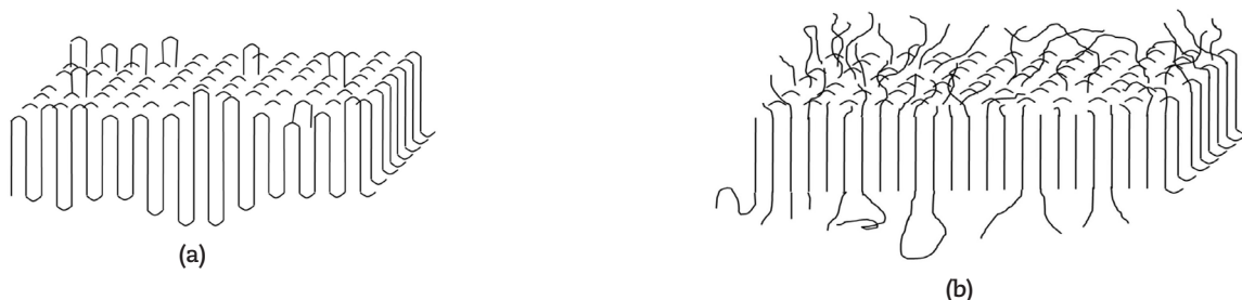
Figura 5. Modelo de cadena plegada: (a) reentrada adyacente, y (b) reentrada no adyacente.
