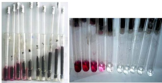
Figura 5. Soluciones de refresco después de ser sometidas a la adsorción sobre columnas con diferentes cantidades de carbón activado. En cada caso se emplearon 1,5 mL de solución 2 \times 10^4 ppm.
