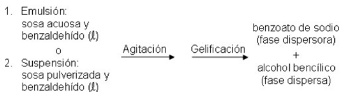
Figura 1. Proceso de obtención de los productos gelificados de la reacción de Cannizzaro a partir de: 1) la emulsión en la técnica tradicional, y 2) la suspensión en la técnica triboquímica.
