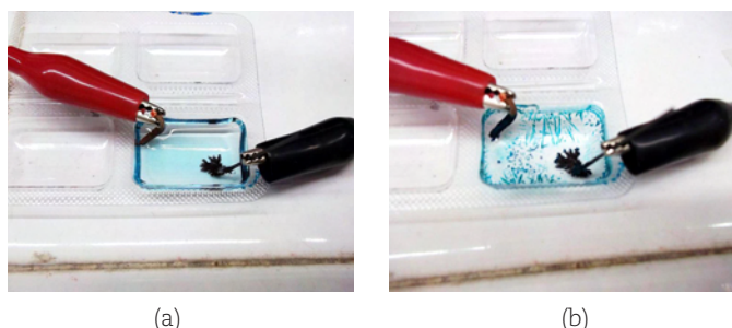
Figura 3. (a) Dispositivo para la microelectrosíntesis de acetato de cobre(II). A unos minutos de iniciada la reacción se observa una solución azul y la formación de cobre metálico en el cátodo (en el caimán negro) si no se le coloca un hisopo; (b) Monocristales y material amorfo de acetato de cobre(II) (material azul del fondo y en las paredes del pozo).
