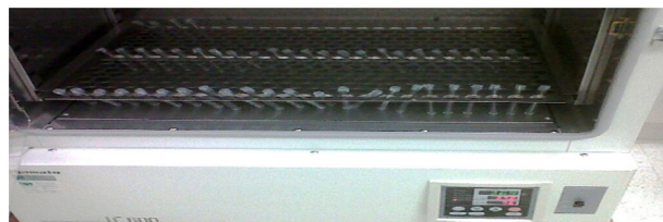
Figura 9 Incubación del inóculo de la muestra en la solución LAL.
