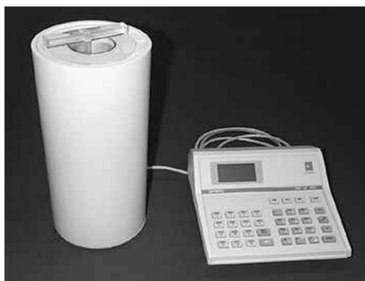
Figura 5 Activímetro CRC-15 PET. Calibración de dosis y medición para vida media.
