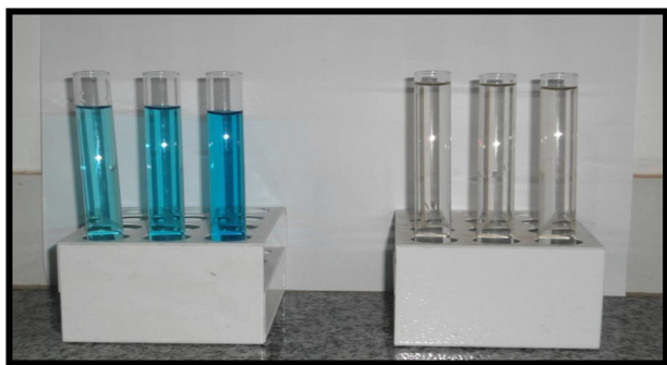
Figura 3 À esquerda estão às soluções de corante a 5 ppm e à direita suas respectivas amostras após a aplicação e decantação do biossorbente lavado.
