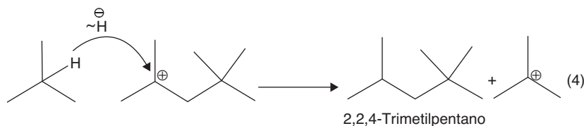
Figura 13 Migración de hidruros. Formación del 2,2,4-trimetilpentano.
