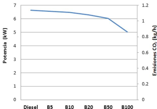
Figura 6. Comportamiento de la potencia y emisiones de CO<sub>2</sub> en relación al tipo de combustible
