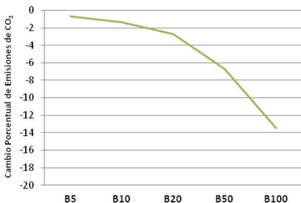
Figura 5. Variación porcentual de emisiones de CO<sub>2</sub> vs concentración de biodiesel
