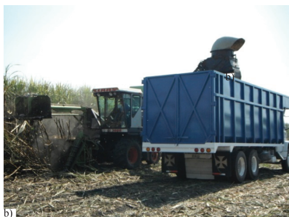
Figura 1. a) corte manual de caña de azúcar en la zona que abastece de materia prima el ingenio caso de estudio y b) corte mecánico de caña de azúcar mediante cortadora marca Class y camión para acarreo de caña
