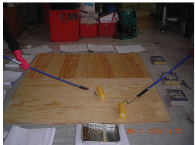
Figura 22. Adición de la resina Epóxica
