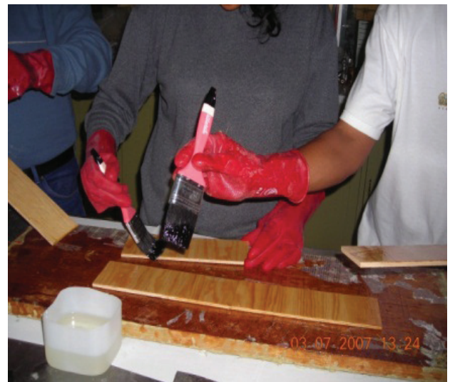
Figura 5. Aplicación del epoxi a la madera
