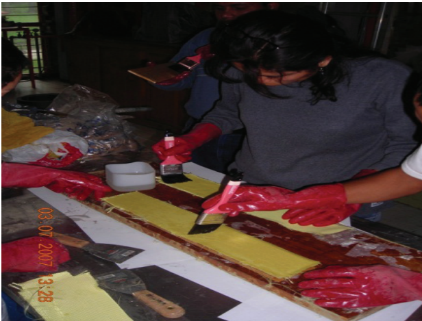
Figura 6. Aplicación del epoxi al Kevlar
