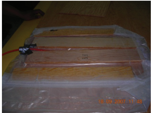
Figura 7. Conformación de los especímenes mediante bolsas de vacío
