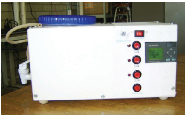
Figura 9. Vista externa del prototipo del irrigador VOR, en la parte superior está la tapa del tanque de agua, botones de selección de temperatura en color rojo y en la parte derecha se encuentra el PLC
