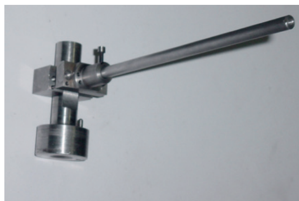
Figura 6. Mecanismo acoplador entre la boquilla de inyección y el excitador
