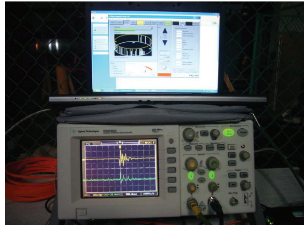
Figura 8. Detección eléctrica y acústica de DP
