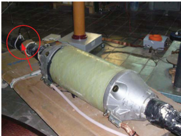
Figura 7. Sensor ubicado próximo a un empalme de alta tensión
