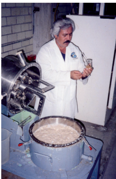
Foto 3. Mezclador de doble planetario para la conversión de ácido algínico en alginato de sodio
