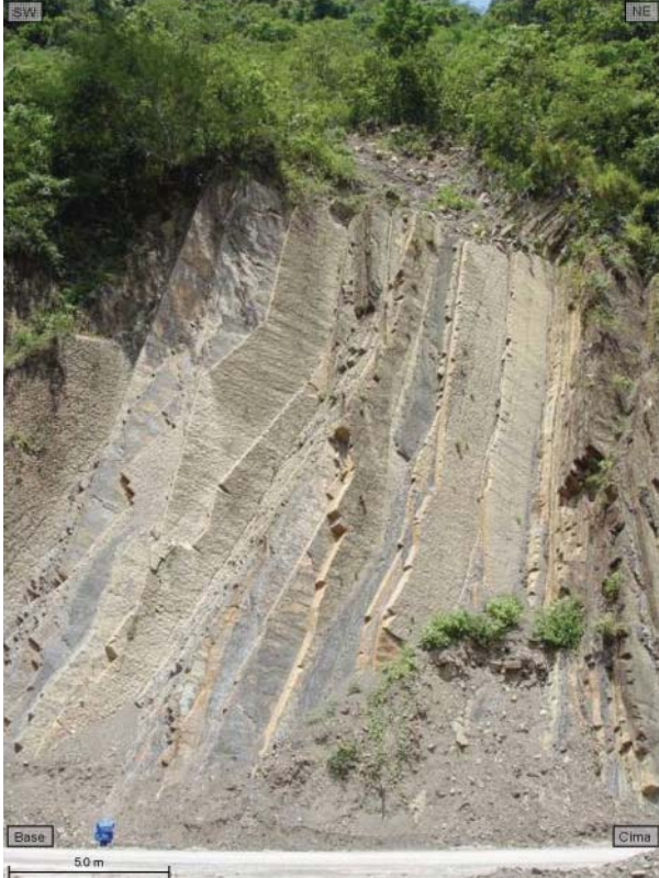
Foto 4.1. Afloramiento de San José-Coacuilco; rumbo general de la secuencia: N 35° W, 64° NE.
