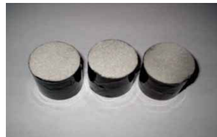
Figura 4. Varistores de ZnO con recubrimiento de resina epóxica en las caras laterales y depósito de electrodos de aluminio en ambas caras planas
