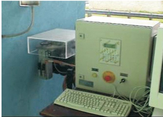
Figura 3. Servomotor y PLC de la instalación
