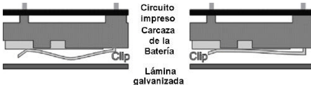
Figura 7. Se puede apreciar el diseño original (a) del sujetador de la batería de memoria del teléfono. La curvatura del clip favorece la presencia de condensado y provoca corrosión galvánica entre el recubrimiento del clip (estaño), y el de la lámina (zinc). Con una modificación (b) en la pieza
