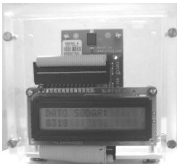
Figura 8. Detalle del trasmisor y de la pantalla de cristal líquido de la unidad remota
