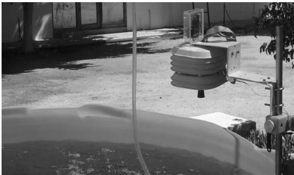
Figura 12. Unidad remota en operación en un tanque acuícola
