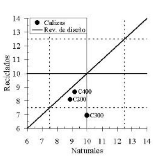
Figura 5. Posicionamiento de revenimientos reciclados-naturales
