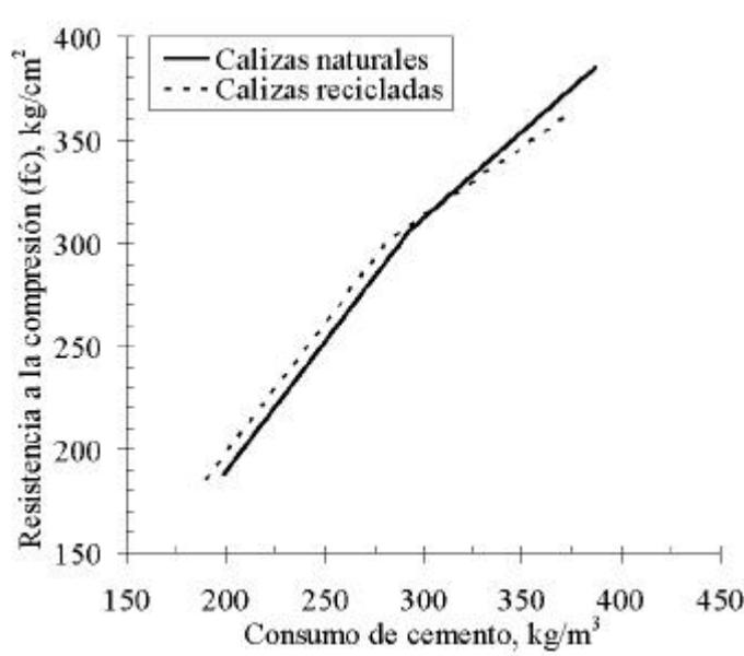
Figura 7. Eficiencia en el consumo de cemento
