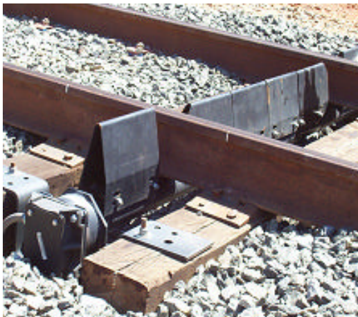
Figura 2. Detector de aparejos caídos
