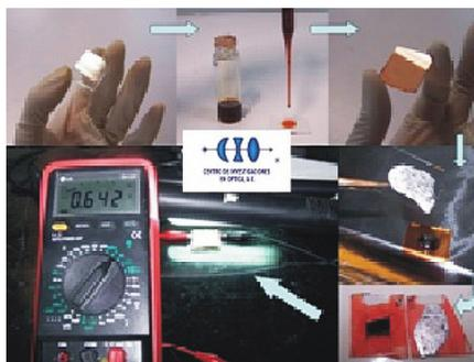
Depósito de películas orgánicas por centrifugación en un sustrato de vidrio con el ánodo (ITO), depósito del metal de Wood (o de Field) y observación de la función fotovoltaica de una celda solar orgánica. El metal de Wood y el de Field pudieran ser una alternativa a los electrodos tradicionales usados
