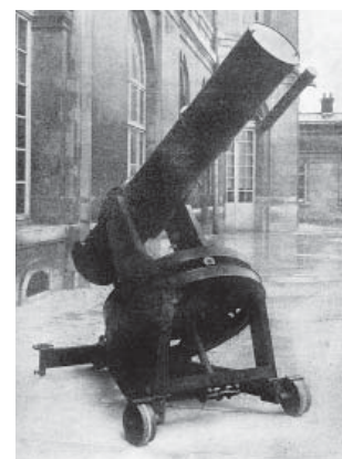
TELESCOPIO CON CONFIGURACIÓN COUDE-CASSEGRAIN
