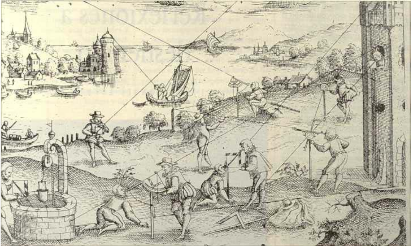
Recursos para medir el tiempo y en los que la técnica del agrimensor saltaron al primer plano. La ilustración aparece en la Teoría y Práctica del Cuadrante Geométrico de Levinus Hulsius (1594) y muestra el uso de la escuadra del agrimensor, cuadrantes, teodolitos, etc. tanto para medir la posición de objetos celestes como la dimensión de objetos terrestres.
