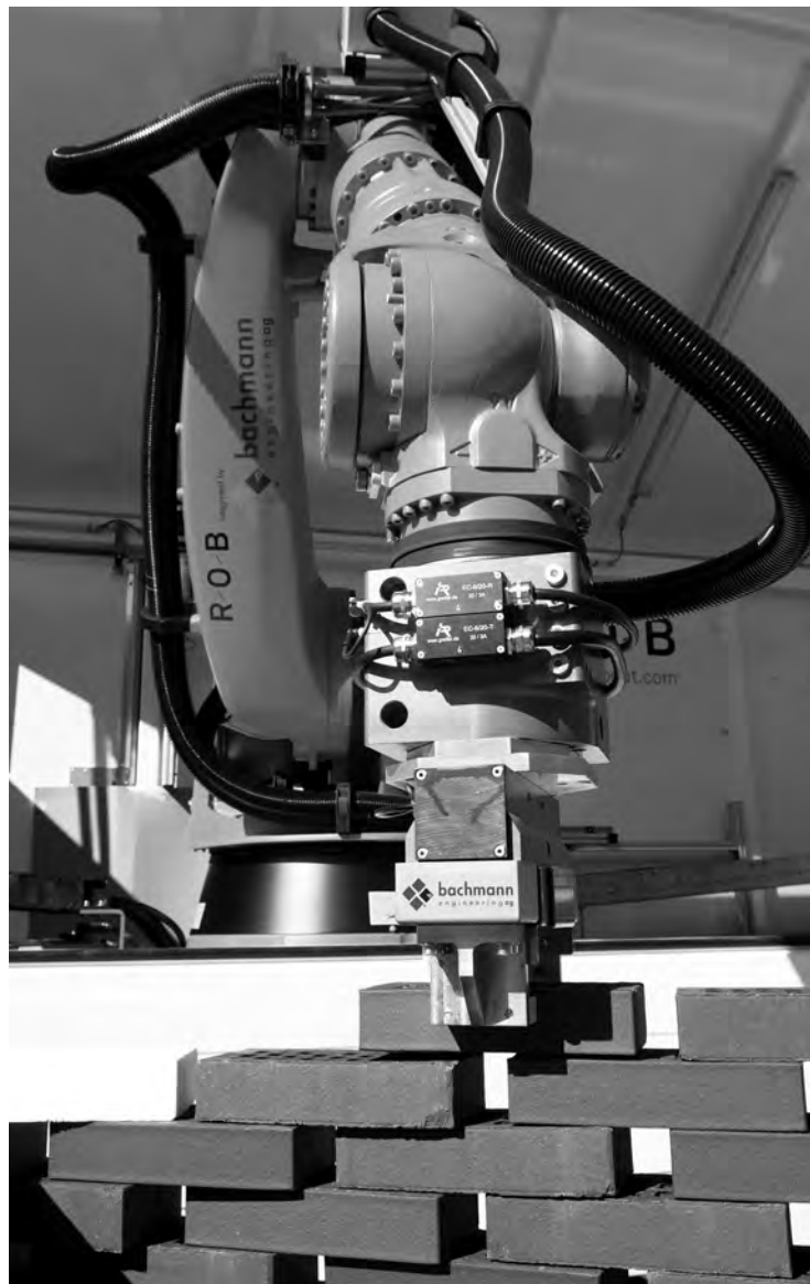
Gramazio & Kohler construcción con brazo robotizado R-O-B. Imagen © Gramazio & Kohler, ETH Zúrich
