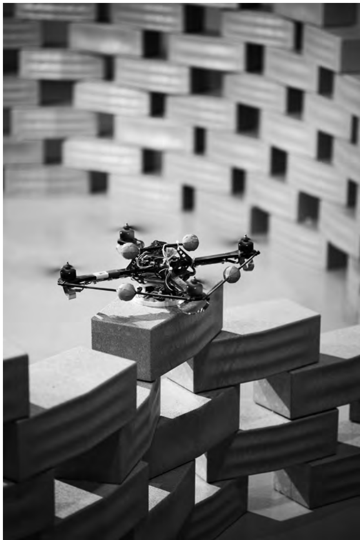
Ambas imágenes: Gramazio & Kohler muros construidos con cuadrícópteros. © Gramazio & Kohler, ETH Zúrich
