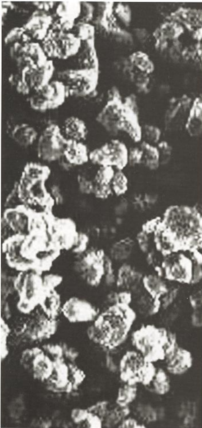
Granos moleculares de cobre nanoestructurado, con diámetros de 0.2 a 0.5 micrómetros, organizados en racimos y observados en un microscopio electrónico.
