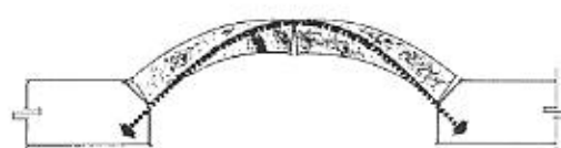
Deformación por aumento de la luz. Grieta por intrados en la clave. Grieta por extrados en arranques; descenso en la clave pero incremento en la flecha real.
