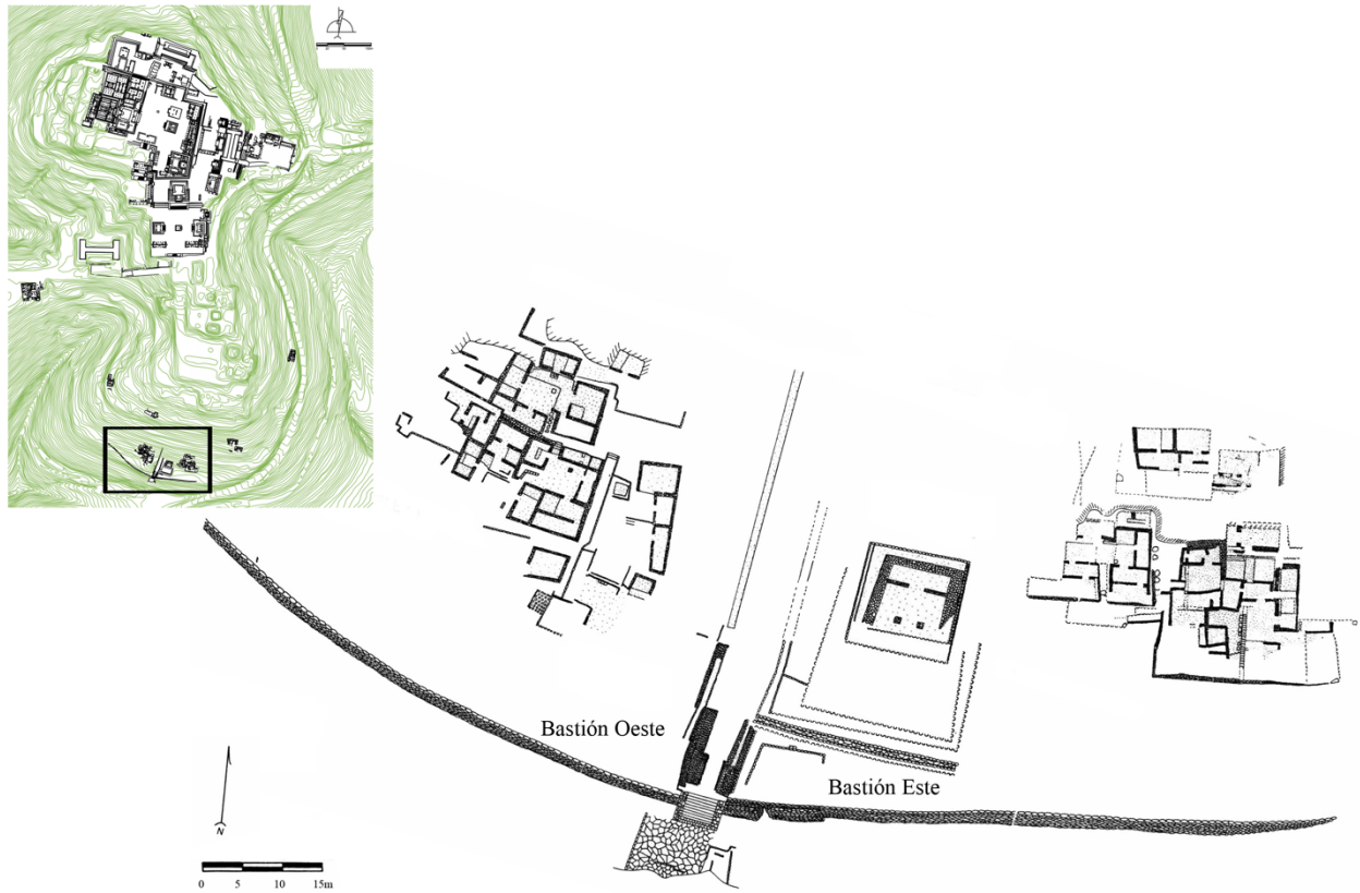
Figura 1. Plano de Loma Sur con el muro de contención delimitando la primera terraza que sostiene, entre otros edificios, a los Bastiones (modificado por Claudia Alvarado para Proyecto Xochicalco).
