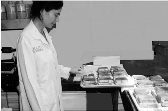
Figura 16. Enriquecimiento químico de los bloques de estuco preparados para los estudios experimentales.
