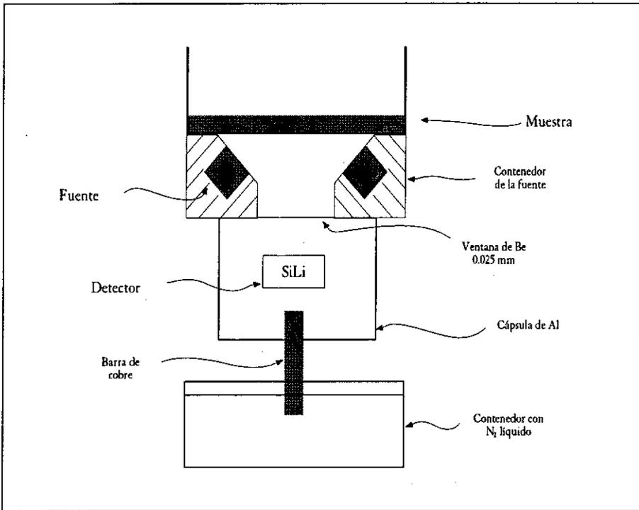
Figura 3. Gráfica del sistema muestra-fuente detector.
