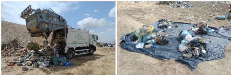
Figura 2. Realização do quarteamento para o ensaio de composição gravimétrica (2021).
