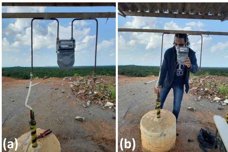
Figura 2. Medidor de vazão de biogás no Aterro Sanitário de Palmas – Tocantins (a) e ajuste do sistema de medição (b).
