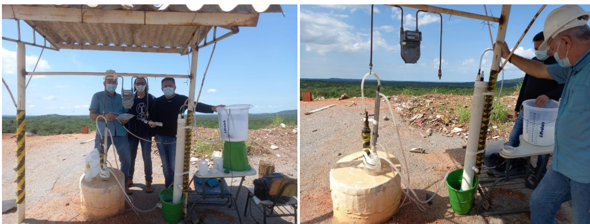
Figura 4. Lavador de biogás empregado nos ensaios.
