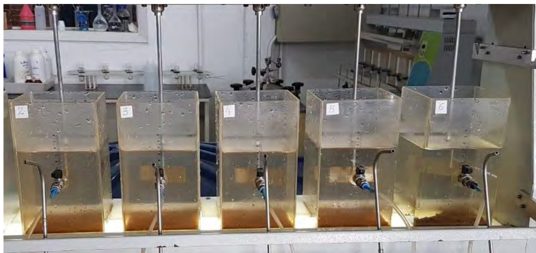
Figura 2. Fim dos ensaios de clarificação da ETA 1 com sedimentação dos flocos.
