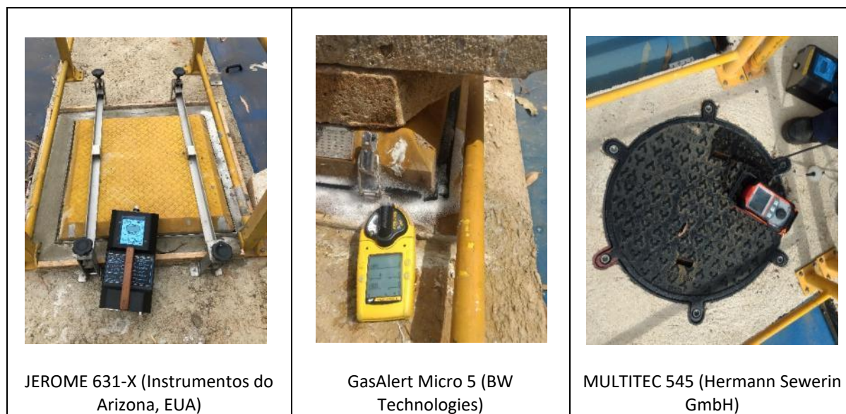
Figura 3. Equipamentos de medição de gases em estações de tratamento de esgotos.
