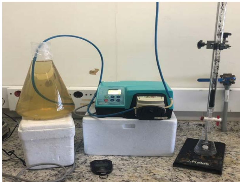
Figura 3. Sistema de bancada de fluxo contínuo em coluna preenchida com lodo de ETA.
