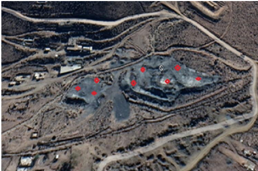
Figura 1. Las zonas de recolección de las muestras del relave, se muestran con los puntos de color rojo. Las coordenadas de la ubicación del relave son: 30° 12' 03" S y 71° 16' 30" W. Fuente: Google Earth, 2023
