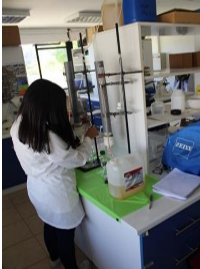
Figura 4. Sistema de lixiviación en columna de fase inversa.
