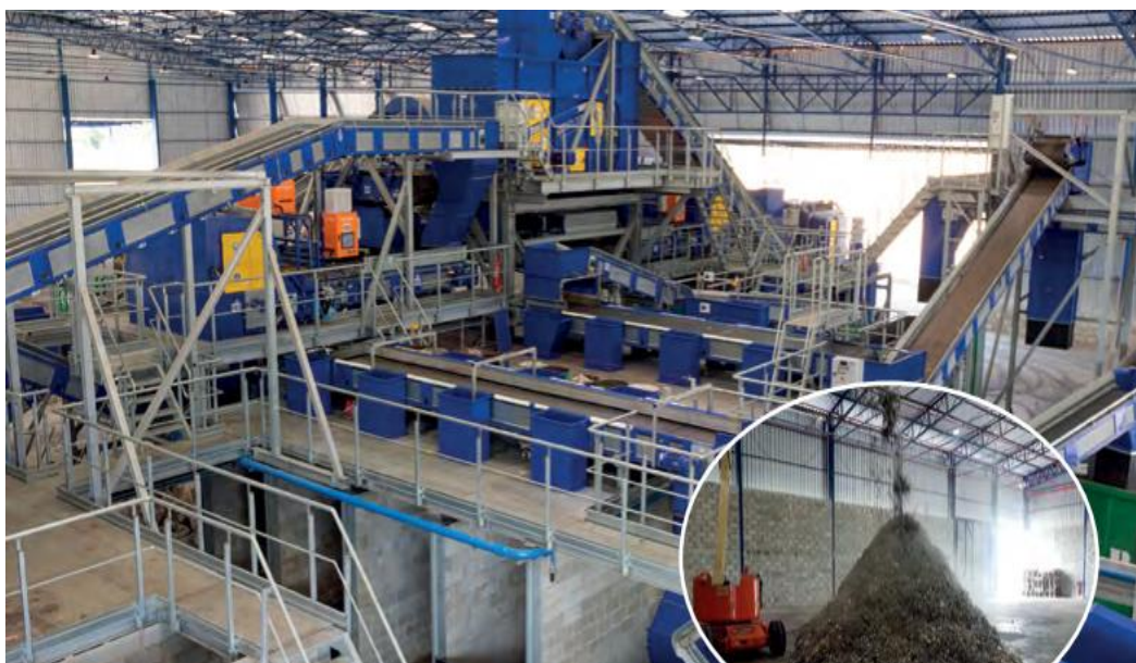
Figura 4. Planta de triagem e produção de CDR em Igarassu-PE. Fonte: autoria própria (2021).
